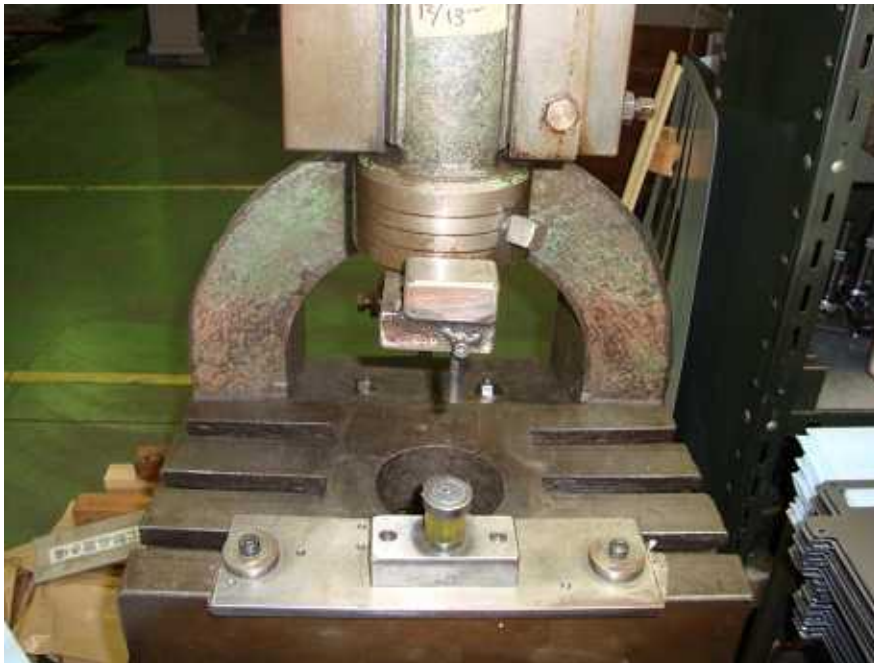
フットプレスによるバーリング加工
