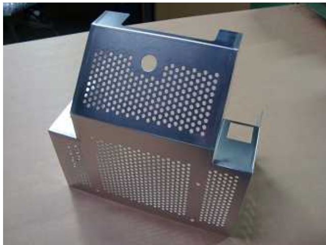
A5052 T = 1.0 NCT加工 + レーザー加工 マウンター用 ヘッドカバー
