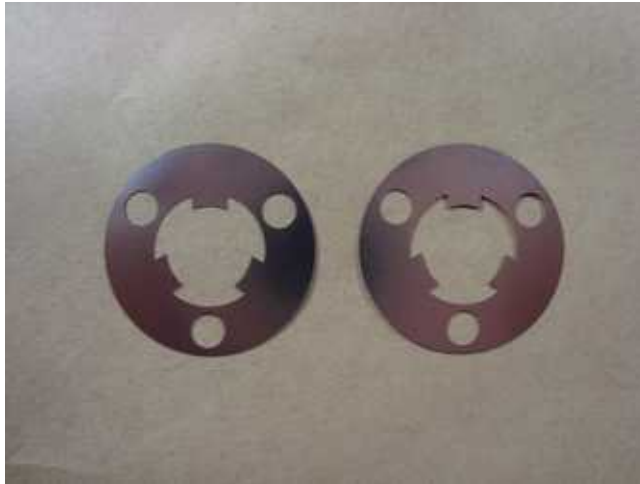
SUS304 T = 0.3 ワイヤー加工 FA機器用 レンズ押え
