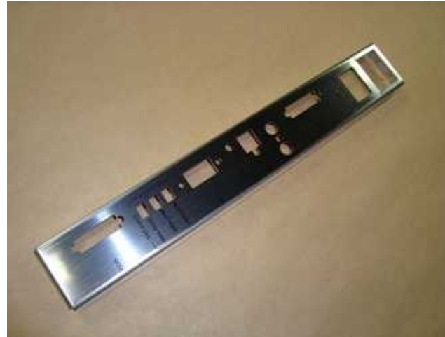
SUS304HL T = 1.5 シルク印刷 レーザー加工 医療機器用 コネクタパネル
