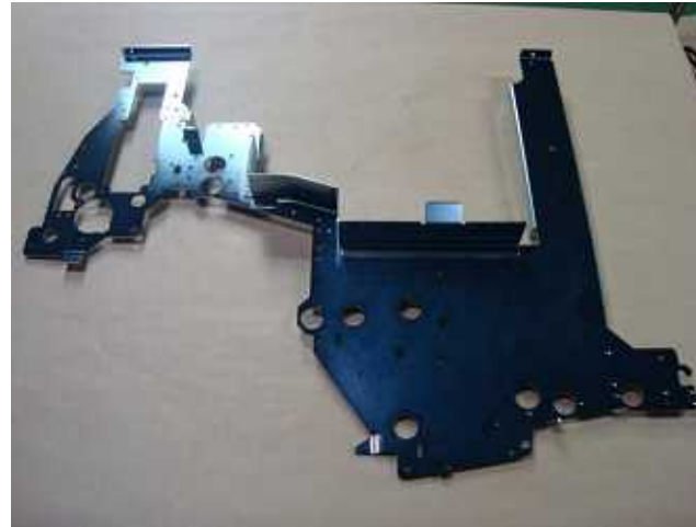
SPCC T = 1.6 亜鉛メッキ NCT加工 + レーザー加工 金融機器用 機構側板
