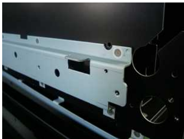
スポット溶接後の部品
